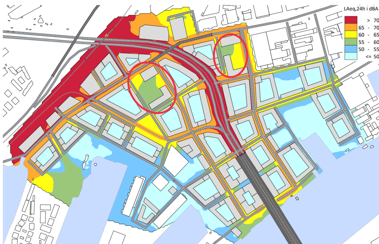
FIGUR 10. RÖDA MARKERING VISAR TVÅ SKOLGÅRDAR DÄR RIKTVÄRDENA ÖVERSKRIDS (FIGUR FRÅN BILAGA 1)
